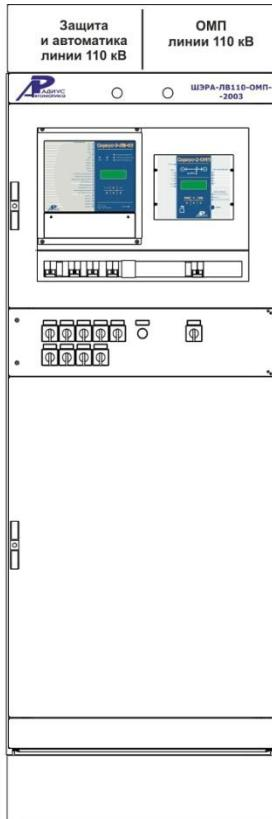
Шкаф резервных защит и АУВ линии 110(220) кВ и ОМП
